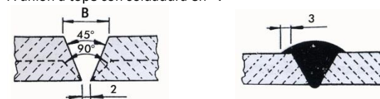
Unión a soldar preparación
