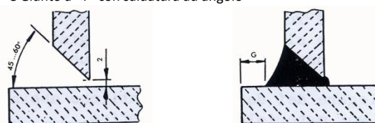
Giunto da saldare preparato
